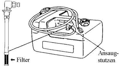
Demontieren Sie den Ansaugstutzen und reinigen Sie den Filter.
