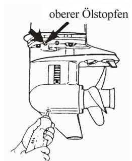
[3] Setzen Sie den oberen Ölstopfen ein, entfernen Sie die Öltube und setzen Sie dann den unteren Ölstopfen ein.
