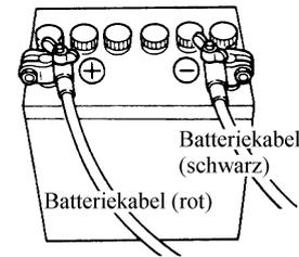
Beim Trennen der Batteriekabel immer das (-) Kabel zuerst abklemmen. Nachdem der (+) Anschluss angeklemmt ist, setzen Sie zur Vermeidung von Kurzschlüssen eine Schutzkappe darauf.
